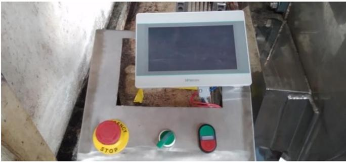
**Figura 6.** Panel de control del fermentador
