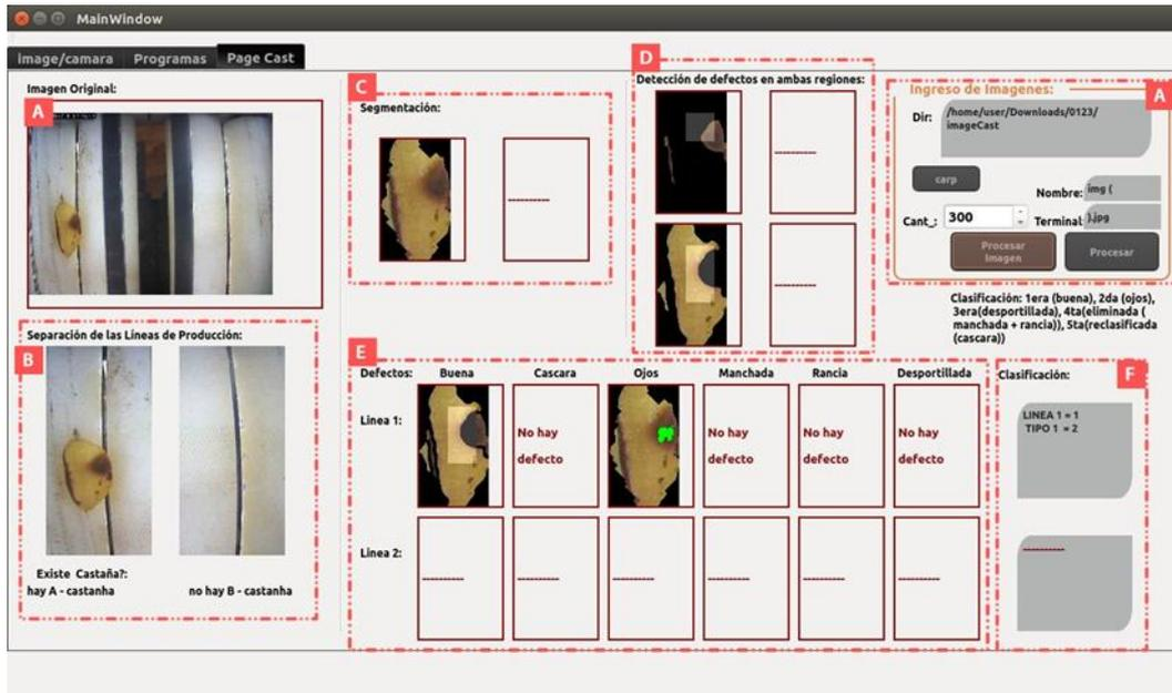
Figura 14. Interfaz de Usuario para la detección e identificación de defectos visuales en Castañas (Automático). Muestra la identificación del defecto de Ojos
