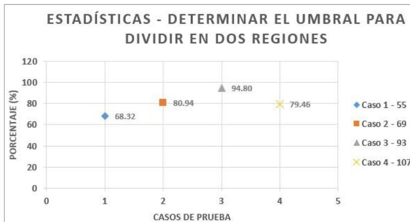
**Figura 5.** Resultado de las pruebas realizadas para encontrar el umbral óptimo al dividir la Castaña en dos Regiones, donde el caso 3 obtuvo una mayor eficiencia que el resto, permitiendo eliminar los problemas en los defectos ojos claros, cáscara y manchada
