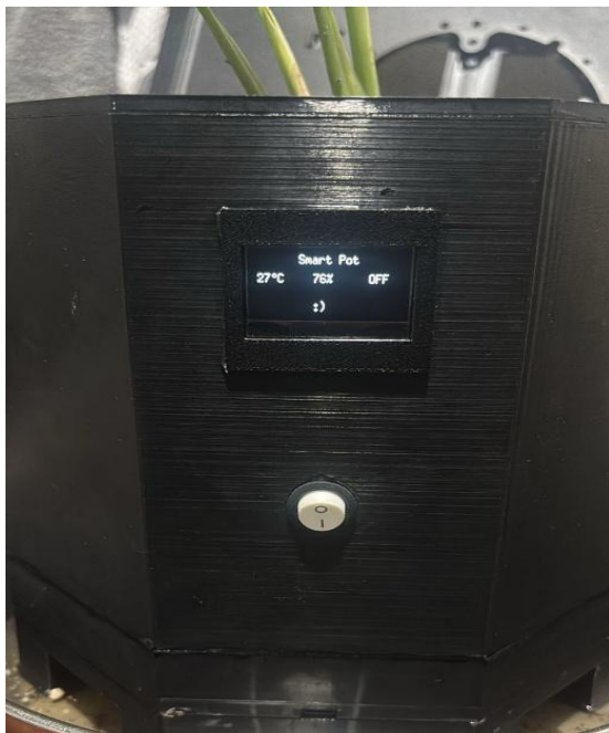
Figura 4. Prototipo físico de la maceta inteligente con pantalla OLED integrada
