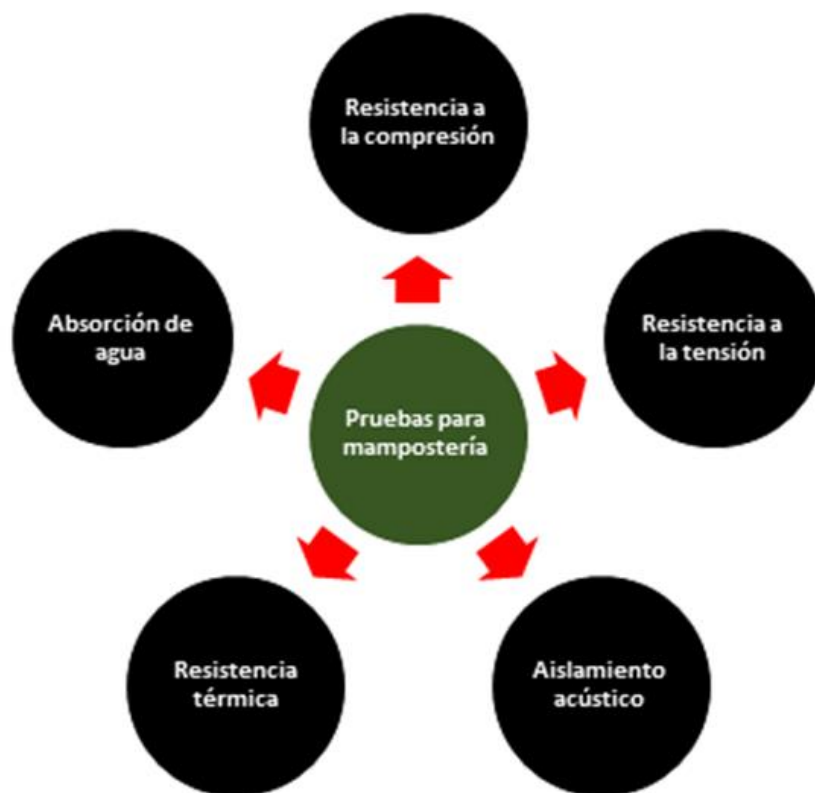
Figura 5. Pruebas necesarias para determinar la viabilidad de uso de mampostería no convencional.
