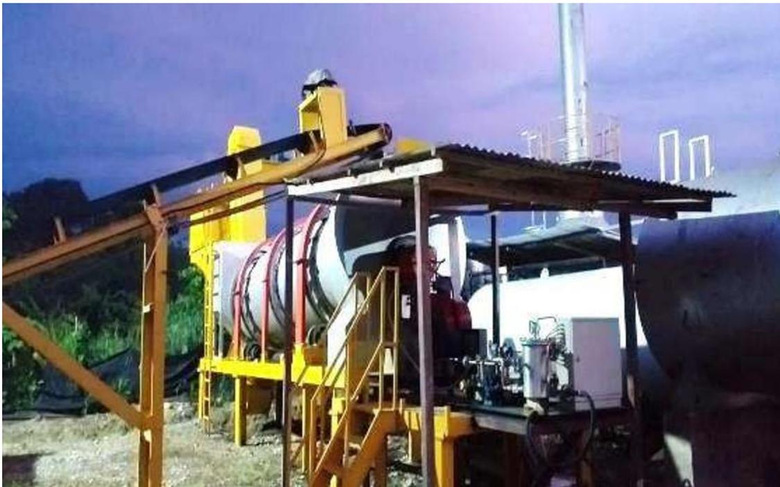
**Figura 3.** Horno rotativo y generador de llama
